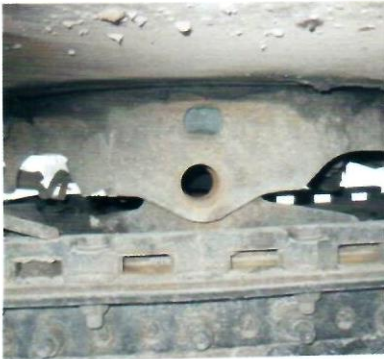
a. (2) (g) Pivot Pin Missing
