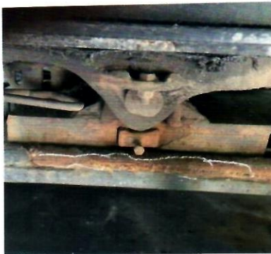
a. (3) (d) Cracked Slider Curl
